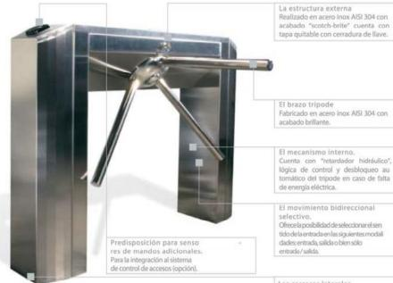
Las carcasas laterales. Realizados en acero inox AISI 304, se pueden quitar para facilitar la instalación y para el pasaje de cables de conexión.
